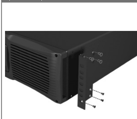
(图 3-a) UPS 支架安装
